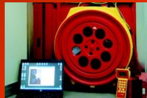
DOOR FAN INTEGRITY
