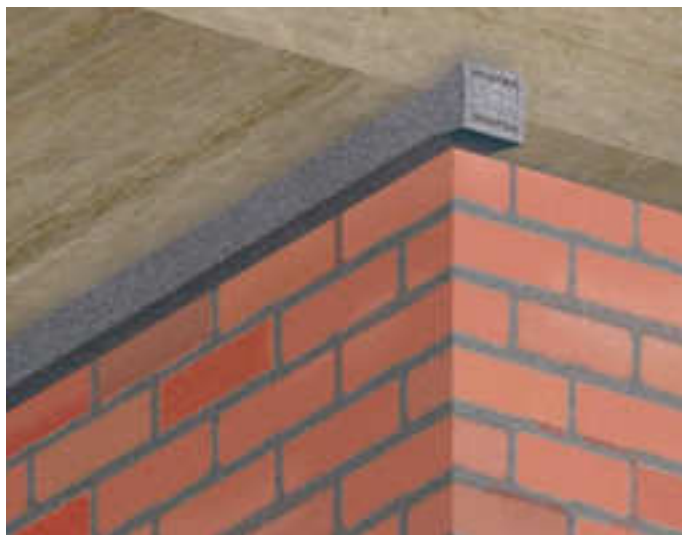
Giunti di espansione
