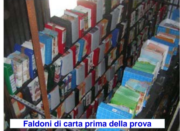
Foto 2: Vista dall'alto di uno dei due carichi d'incendio, allestiti nelle due scaffalature metalliche, di lunghezza 9,15 m ed altezza 4,00 m, utilizzate durante le prove.
