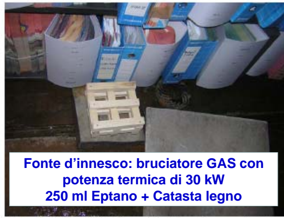
Foto 7: Particolare della fonte d'innesco utilizzata durante le prove e realizzata da un bruciatore a gas con potenza termica di 30 Kw e da una catasta di legno posta in una vasca d'acciaio contenente 250 ml di eptano.
